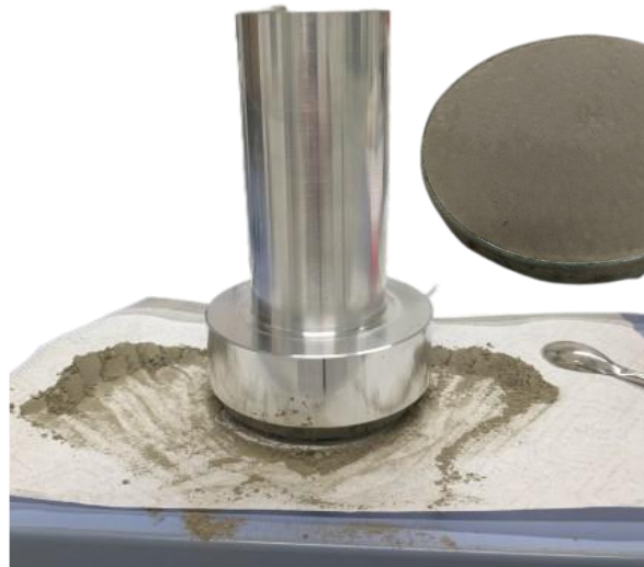
Figure 2-24 : Préparation des échantillons pour l'étalement des gouttes
