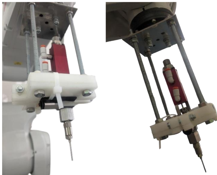
Figure 2-7 : Photos de la pince fixée sur le bras articulé
