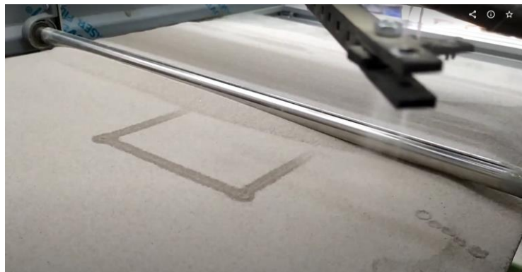
Figure A-1 : Dépôt d'une nouvelle couche de poudre sur une précédente (test avec du sable uniquement)
