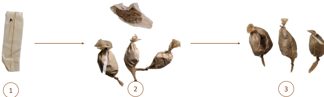
Figure 1-4 : Photo des échantillons de chanvre préparés pour mesurer leur absorption en eau
