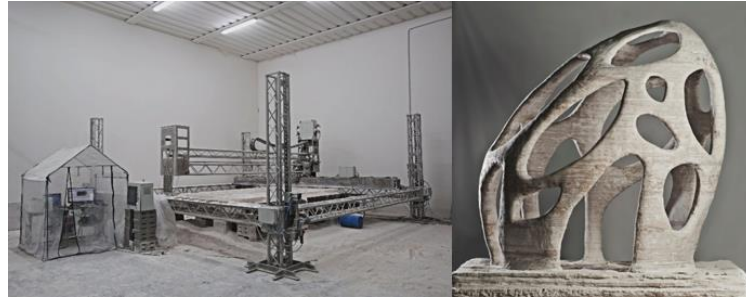
Figure 1-2 : Imprimante D-Shape (gauche) et le Pavillon Radiolaria (droite) d'après [4]
