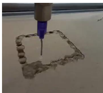
Figure A2 : Injection sélective du liant sur la nouvelle couche de poudre - Trajectoire en spirale (Test formulation avec éther de cellulose)
