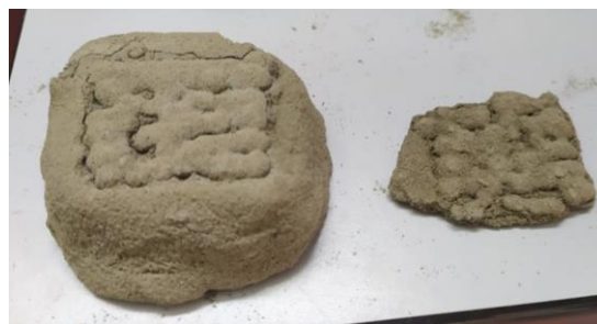
Figure 3-5 : Photo du décollement de la première couche du premier cube imprimé en raison d'une grande adhérence au lit de particules.
