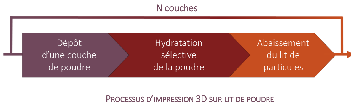
Figure 1-1 : Processus d'impression 3D sur lit de poudre de matériaux cimentaires
