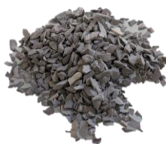
Figure 1-2 : Photo des granulats de pâte de ciment recyclée (Classe : 1-2 mm)
