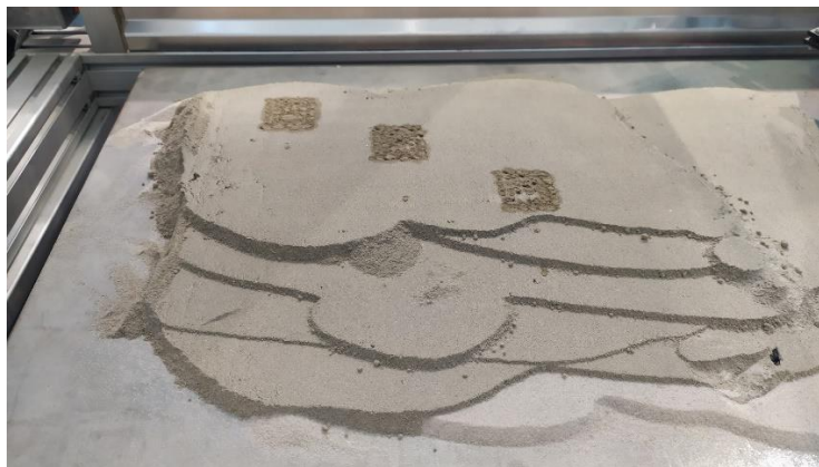
Figure A3 : Aspect de l'impression après le dépôt de plusieurs couches (Test formulation mortier classique)
