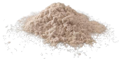
Figure 1-1 : Photo de la chènevotte broyée utilisée pour l'impression
