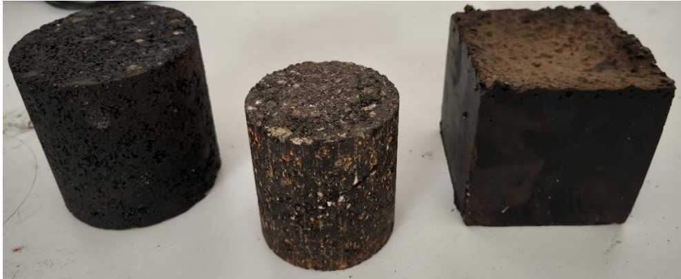
Figure 27 : Matériaux monolithiques enrobés, de gauche à droite : NA2, RA1, NA7
