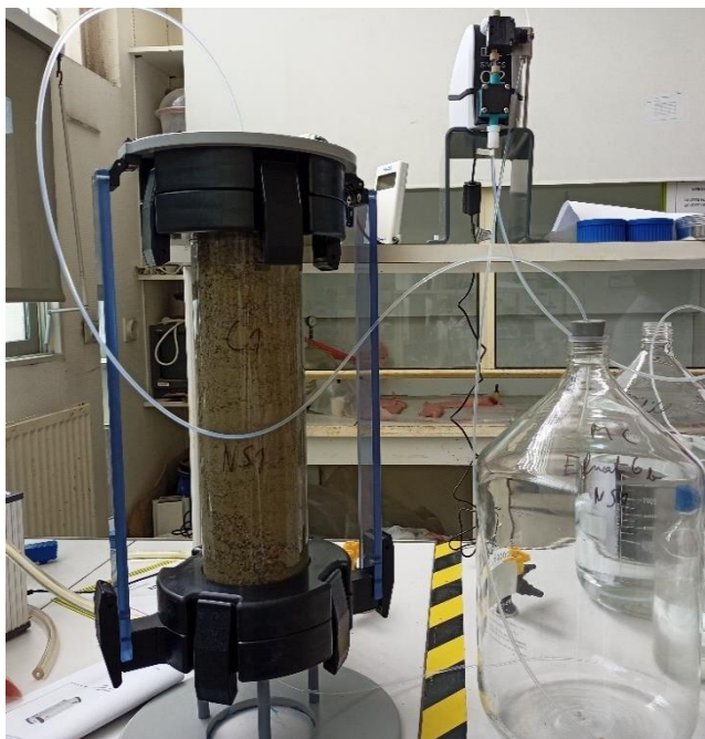
Figure 33 : Montage expérimental de l'essai de percolation à courant ascendant
