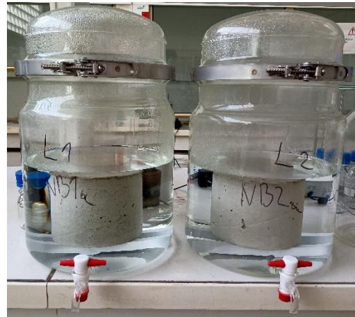
Figure 31 : Essai de lixiviation dynamique des surfaces
