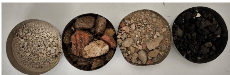
Figure 25 : Granulats recyclés, de gauche à droite : RS2, RG3, RG15, RG13
