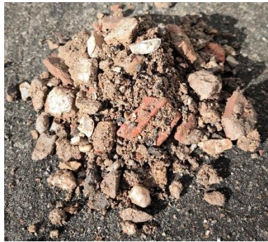
Figure 18 : Granulats recyclés mixtes
