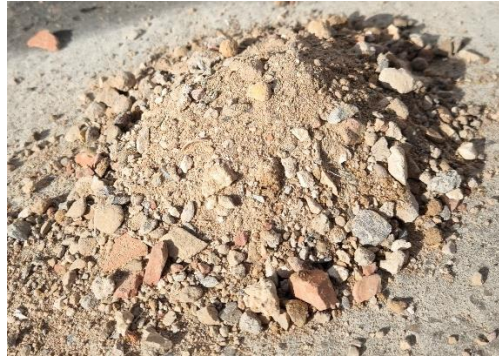
Figure 16 : Granulat de béton recyclé
