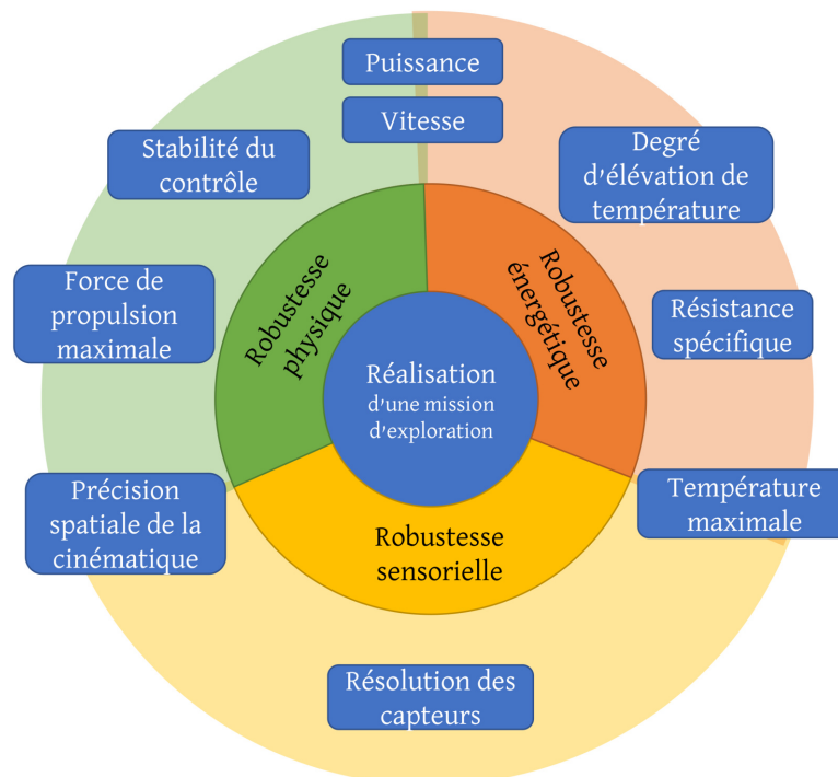
FIGURE 3.2. – Diagramme des indicateurs de performance d'un hexapode dans le cadre d'une mission d'exploration. Les indicateurs sont indiqués en bleu. Les sections du cercle représentent les catégories de performances.
