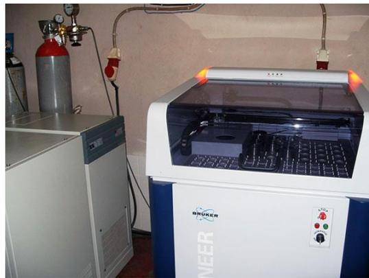
Figure 2. 9. Spectromètre de fluorescence X BRUKER S4
