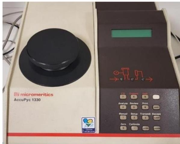
Figure 2. 5. Pycnomètre à hélium e type Accupyc 1330 (Microméritics)
