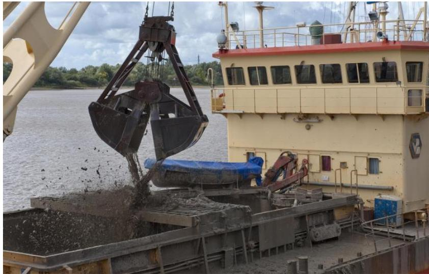
Figure 1. 1.Opération de dragage de sédiments (baie de Seine 2016)[38].
