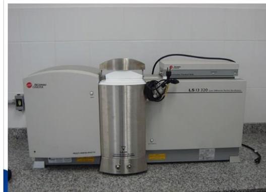
Figure 2. 7. Granulométrie laser (Analyse par diffraction laser) COULTER
