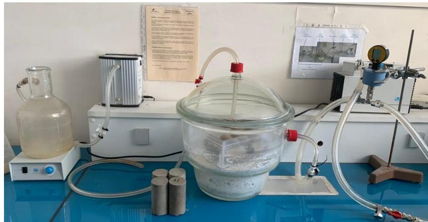
Figure 2. 18.Saturation à l'éthanol
