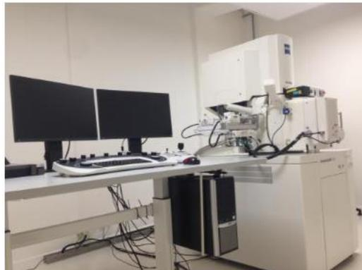
Figure 2. 13. microscopie électronique à balayage (MEB) ZEISS GeminiSEM 300
