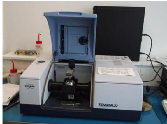
Figure 2. 12. Spectroscopie Infrarouge BRUKER Tensor 27
