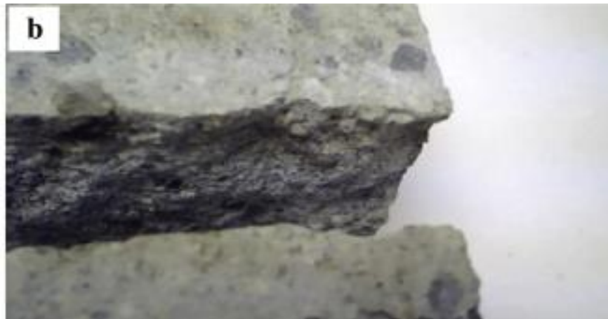
Figure 47 : Exemple de rugosité d'une fissure créée dans un mortier. [Akhavan et al., 2012]
