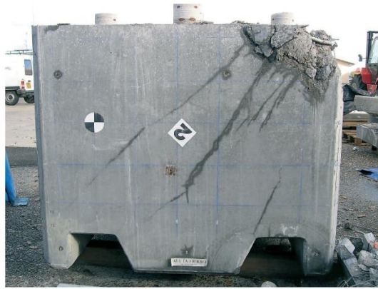
Figure 4 : Conteneur B2.1 inactif après un essai de chute (photo issue des conditionnements actuels pour les déchets de MAVL, [CEA, Bigot et al, 2008].
