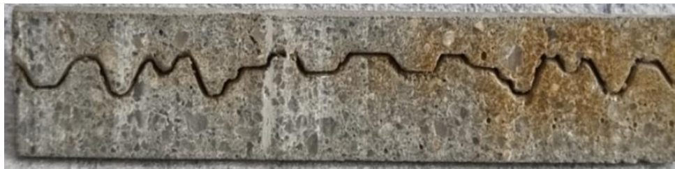
Figure 33 : Barreau de mortier fissuré obtenu après l'étape de dissolution. Le barreau a été découpé longitudinalement afin d'exposer sa fissure interne.
