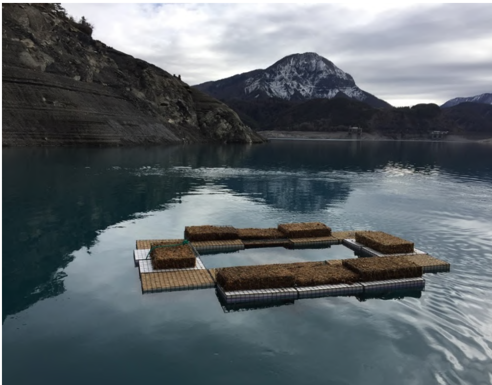
Figure 3 : Photographie du premier prototype test de 15m 2 installé en mars 2017 sur la retenue de Serre-Ponçon. ©ECOCEAN (Projet UROS)
