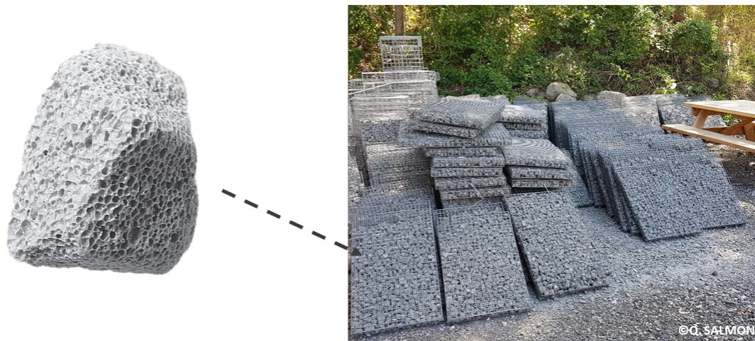
Figure 7 : Photographie d'une Misapor® en gros plan (Gauche). Image tirée du site internet du fabricant ( www.misapor.ch ) ; (Droite) Cages grillagées contenant de la Misapor® et utilisées comme substrat dans les FLOLIZs. ©Projet UROS
