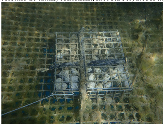
Figure 3 : Photographie d'un substrat amovible (20 x 25 cm) rempli de Misapor®.
