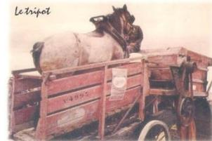
La mécanisation, fruit des astuces des agriculteurs, permet d'importants gains de productivité. Le tapis roulant du tripot, actionné par le cheval, est ainsi très vite remplacé par le tracteur.
