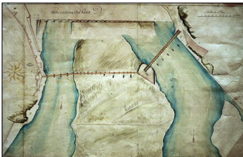
Fig. 169 - Plan des Ponts d'Avignon [1770], signé « Lu et approuvé : Fortia » - (AN) Légende : A - Massif du côté de Villeneuve ; B - Massif au bord de la Barthelasse ; C - Pont de bois dans l'île de la Barthelasse ; D - Pont de pierre de Saint-Bénézet ; E - Ile de la Barthelasse ; F - Partie de la ville
