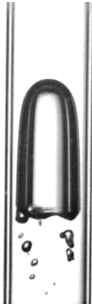
Figure 137. Ecoulement intermittent à poche – D_t=0,028 m
