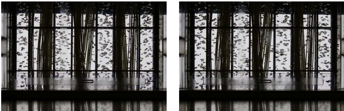
Figure 130. Visualisation écoulement fines bulles Hors Faisceaux pour un débit d'air SAD_m = 0,2 \text{ Nm}^3.\text{h}^{-1}.\text{m}^{-2} . Vitesse d'obturation 1/4000s.
