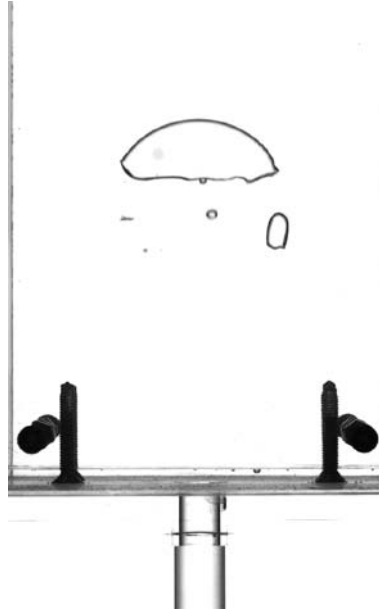
Figure 140. Illustration de la reformation rapide de la poche isolée en aval de la restriction. Obstruction 60% - élévation h=5 mm
