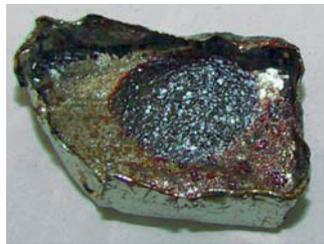
**Figure n° 97: Croissance cristalline après incorporation de 4% mas. de  $\text{LiBO}_2$  dans une céramique de TTB samarium**
