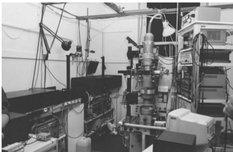
Figure 2.4 : TEM Dynamique (DTEM) dans le laboratoire d'Oleg Bostanjoglo basé sur un TEM Siemens commercial de résolution spatio-temporelle 200ns & 10ns. 34
