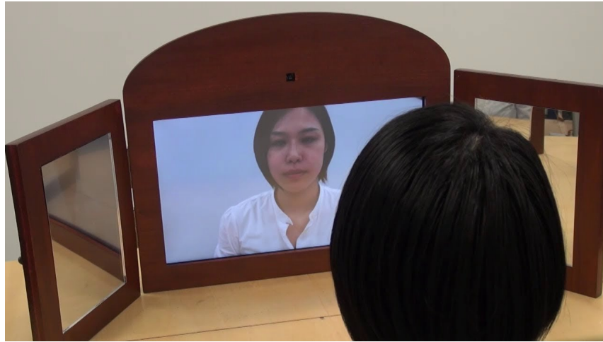
FIGURE 6.1 – Dispositif Face Transformation Mirror : Miroir déformant l'image du participant pour lui donner l'impression de sourire (Yoshida et al., 2013)
