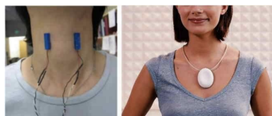
Gauche: Tests en laboratoire du dispositif de stimulation vibratoire de MyVoicePlus™. Droite: premier prototype du dispositif.
