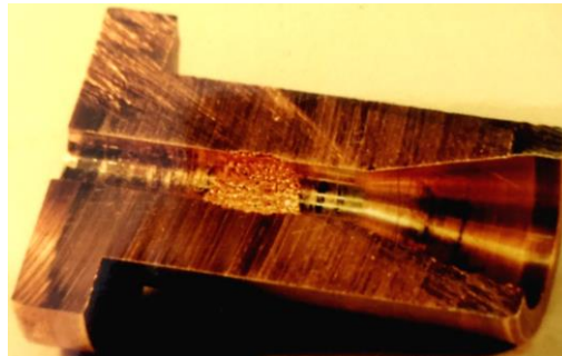
Figure I.35 : Photographie de la surface interne d'une tuyère usée [63].
