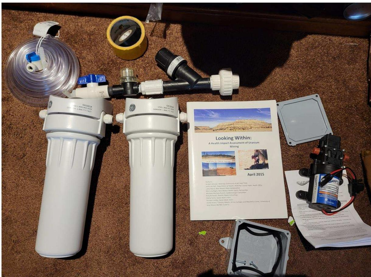
Figure 37. Photo du matériel de Carry permettant de filtrer l'eau et de la rendre apte à la consommation. Grâce à l'énergie solaire et à un équipement de qualité, Gallup, février 2022.
