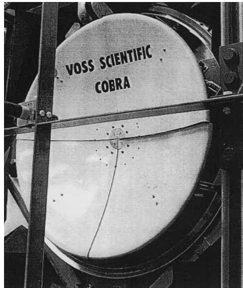
Figure 4.6: Exemple d’une antenne parabolique baptisée COBRA, d’après [99].
