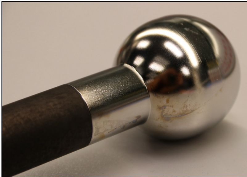
Figure 3.30: Photographie des embouts de cathode montrant une potentielle fuite des électrons en dehors de la zone d'interaction et/ou une potentielle émission électronique.
