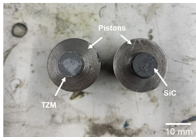
Figure 86 Image d'un assemblage préparé pendant 1 h à 1700 °C sous 60 MPa ayant rompu immédiatement après l'étape de séchage de la colle
