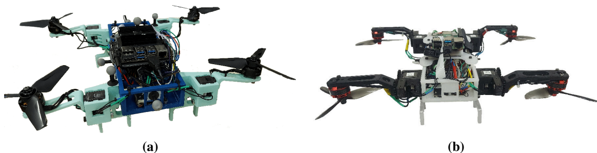
Figure 1.17: Les deux versions du Xtilt développées dans les travaux de thèse, (a) la version 1 avec une carte Nvidia Jetson Nano, (b) la version 2 avec un contrôleur basée sur la Raspberry pi4. La distinction dans le positionnement des hélices doit également être relevée.
