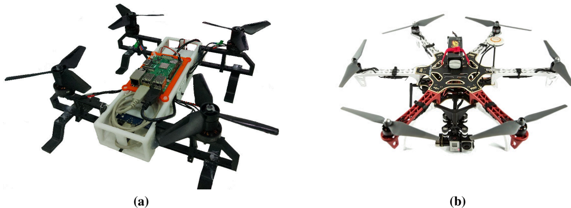
Figure 1.13: Exemples de drones sous-actionnés (a) Xdrone quadricoptère, (b) DJI F550 hexarotor
