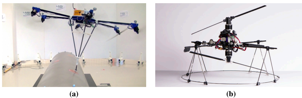
Figure 1.14: Exemples de drones totalement actionnés (a) Tilt-Hex [19] source image , (b) Hélicoptère coaxial [18] source image
