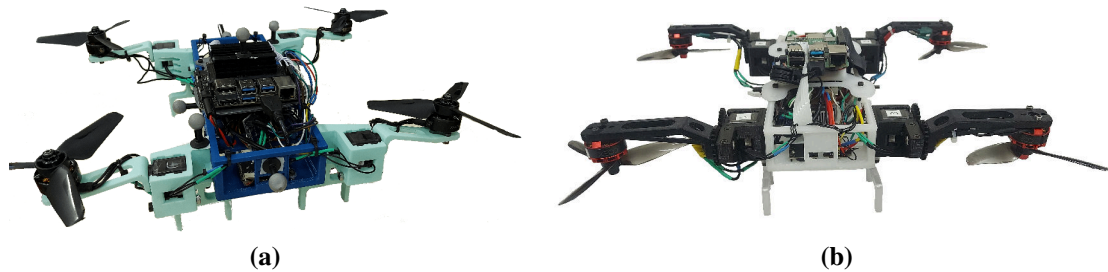
Figure 5.19: Les deux versions du Xtilt, (a) la version basée sur la carte Nvidia Jetson Nano, (b) la version basée sur la carte Raspberry pi4. Il convient également de noter la différence de positionnement des hélices.
