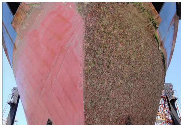
Figure 13 : Exemple d'une surface après biofouling à droite et avant à gauche (extrait de [114]).
