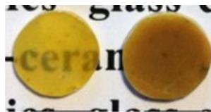
Figure I-26 : Vitrocéramiques de  $\text{TeO}_2$  obtenues par frittage SPS à partir d'une poudre de verre de composition  $85\text{TeO}_2-15\text{WO}_3$  (%mol). Essais réalisés sur une poudre grossière, compactée et pré-frittée à  $350^\circ\text{C}$  et avec utilisation d'une barrière thermique d'alumine lors du frittage [61].
