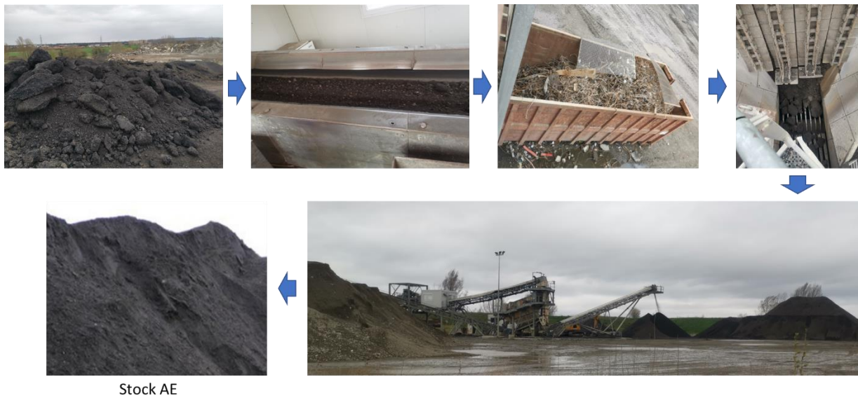
Figure 14 Production des AE (photos prises lors de la visite à la centrale Ambromat pour le traitement des déchets à Toulouse, 2020)
