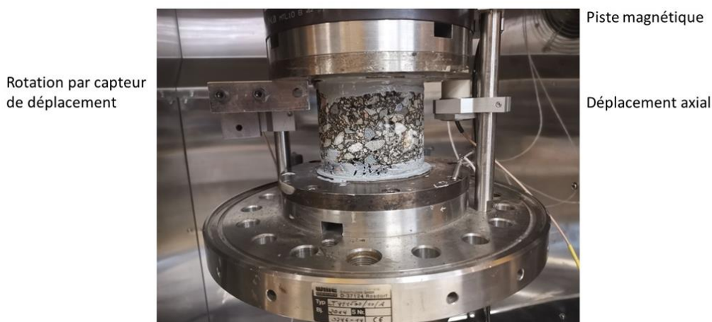
Figure 81 Capteurs de déplacement
