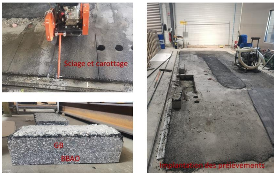
Figure 73 Découpage des plaques d'enrobé
