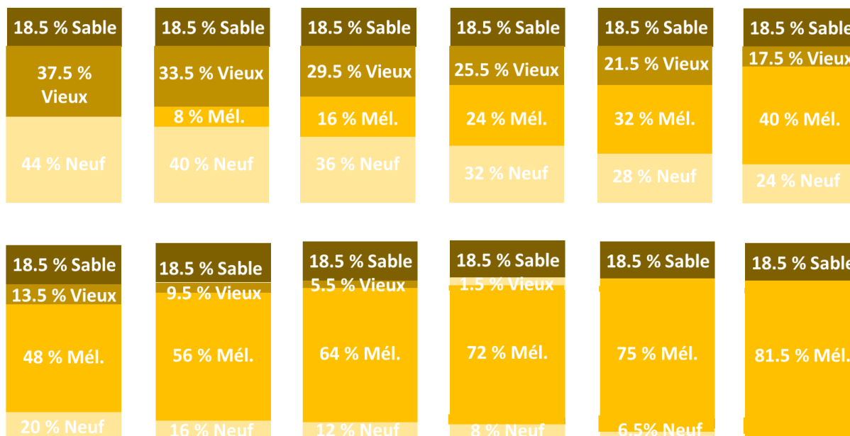
Figure 107 Les différentes étapes de mélange entre les constituants neuf et vieux
