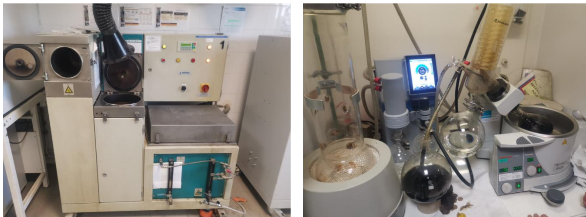
Figure 41 L'Asphaltanalysator (gauche) et l'évaporateur rotatif (droite)
