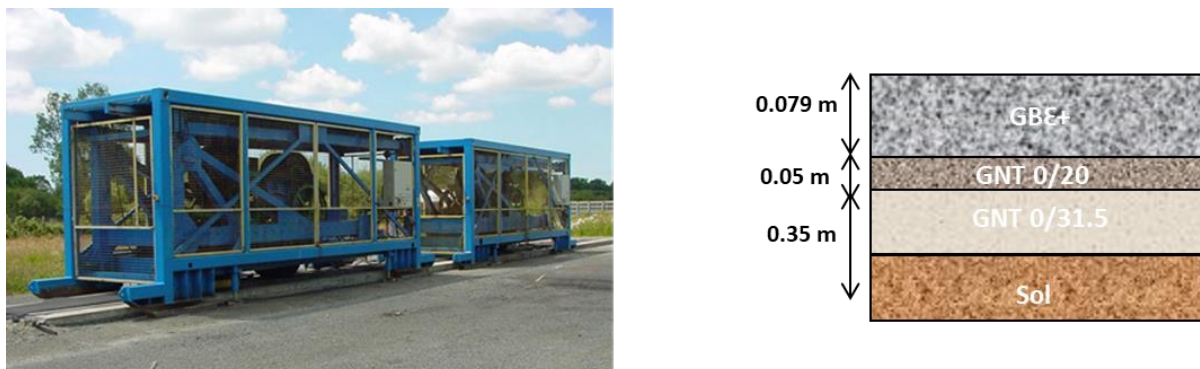
Figure 169 Machine Fabac (gauche) et structure testée (droite)
