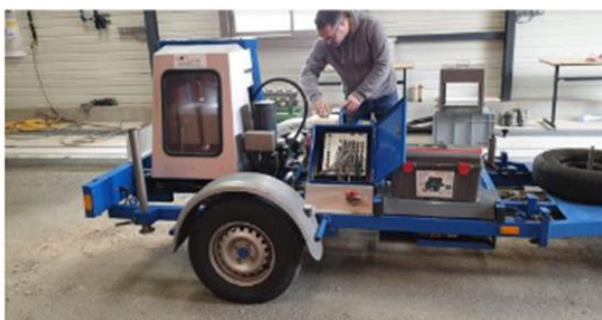
Figure 133 Essai FWD (gauche) et son principe de fonctionnement (droite)
