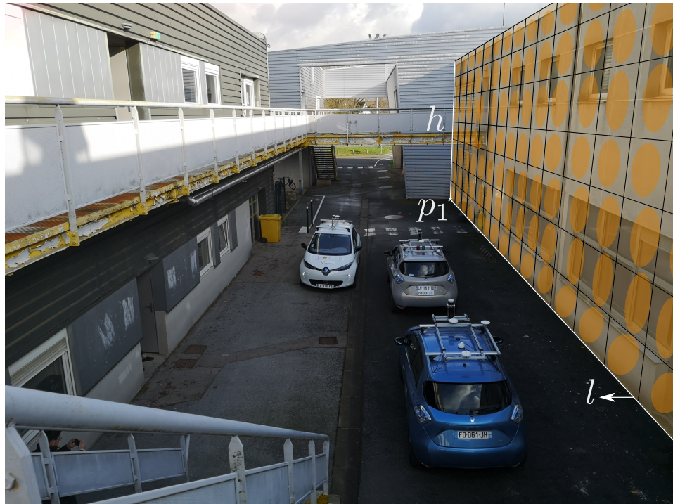
FIGURE 5.1. – Véhicules utilisés avec leurs capteurs, dans un environnement difficile constitués de bâtiments métalliques avec des passerelles. Une grille de ND verticale est représentée sur une façade.
