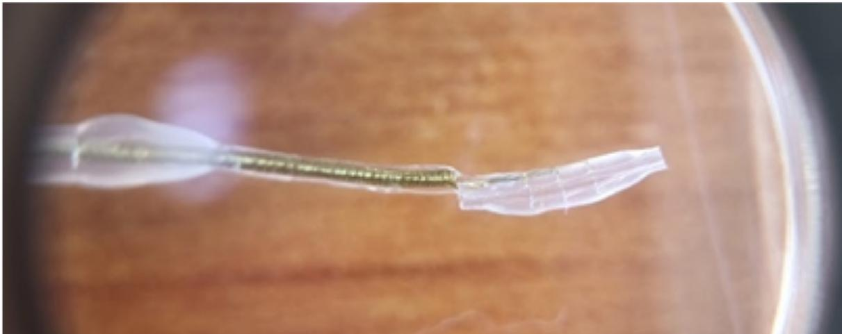
FIGURE 3.4 – Sonde *Micro Nerve Cuff* développé par Microprobes (vue microscope).
