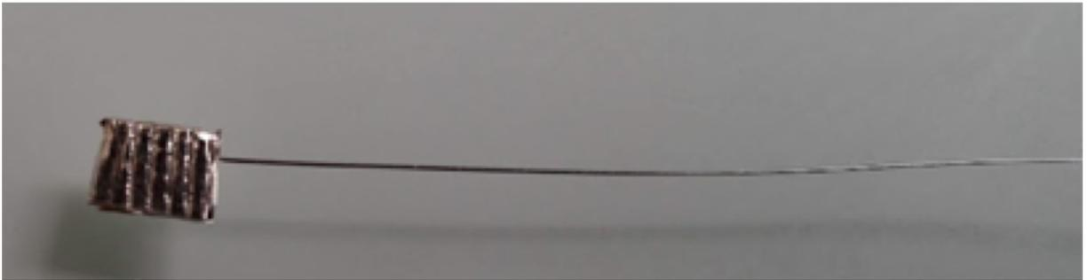
FIGURE 3.5 – Sonde ECG développée par Gabriel Dieuset. L'électrode est positionnée à gauche et le câble en inox à droite.
