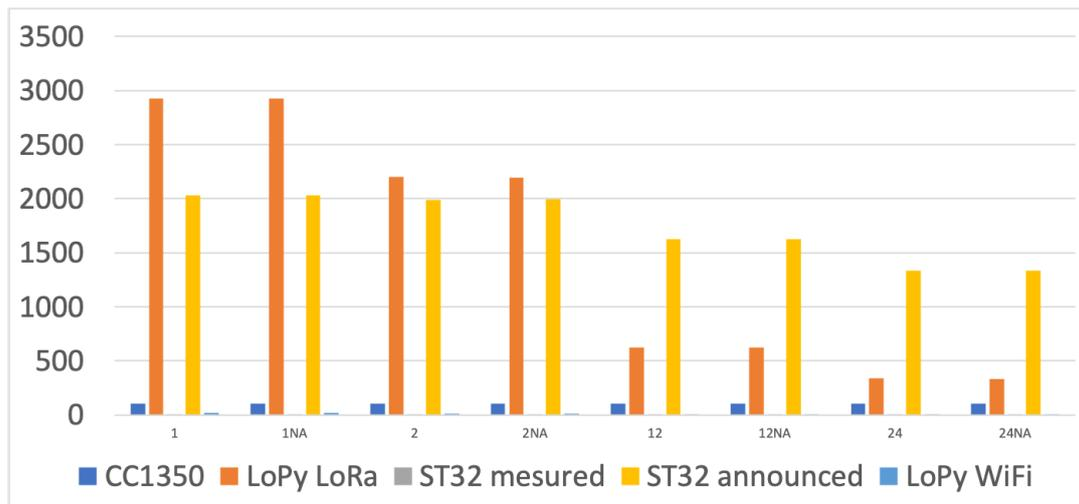
FIGURE 5.12 – Durée de vie des différents capteurs pour un nœud relais avec 1 nœud isolé
