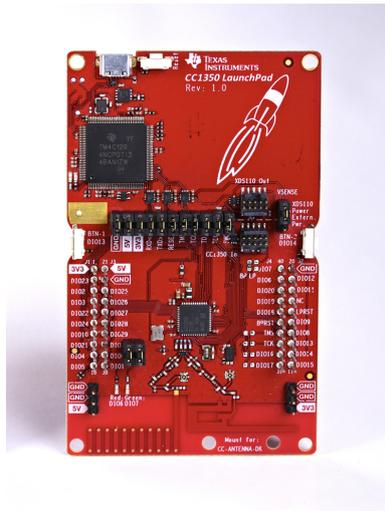
FIGURE 3.13 – Capteur Ti LAUNCHXL CC 1350
