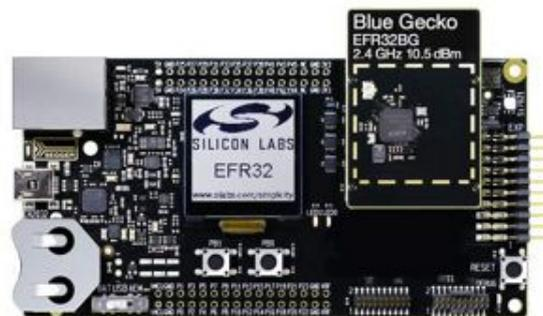
FIGURE 3.16 – Capteur EFR32BG SLWSTK6020B
