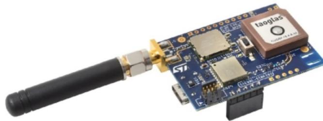
FIGURE 3.10 – Capteur STEVAL STRTK01
