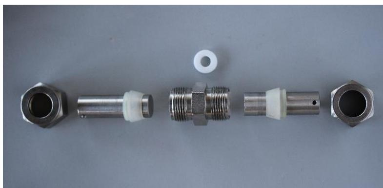
Figure II-4 : Photo d'une cellule Swagelok et de l'anneau en Teflon utilisé pour les mesures de conductivité des liquides ioniques non-confinés.
