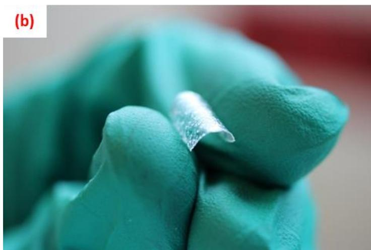
Figure IV-13 : (a) Schéma de l'assemblage de la cellule utilisée avec un électrolyte ionogel. (b) Photo de l'un des films de ionogel utilisés.
