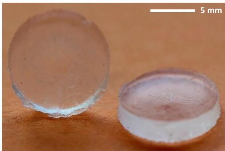
Figure II-2 : Pastilles de ionogel [PVDF]/EMImTFSI 17/83 wt%.
