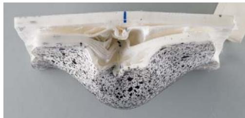
**Figure 144 :** Plaque de HB26 après impact de la munition de calibre 7,62 mm à 800 m/s.
