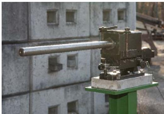
Figure 130 : Canon utilisé pour les tirs balistiques.
