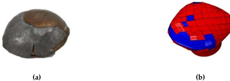
**Figure 162 :** Comparaison post-mortem de la munition de calibre 9 mm obtenue en : (a) essai balistique ; (b) simulation numérique.
