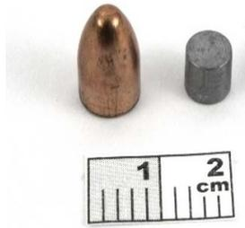
**Figure 27:** Munition de calibre 9 mm étudiée et éprouvette obtenue après usinage.
