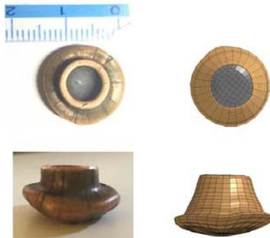
**Figure 22** : Comparaison entre la déformation de la munition de calibre 9 mm expérimentale et numérique lors d'un impact sur un casque en Kevlar®[119].
