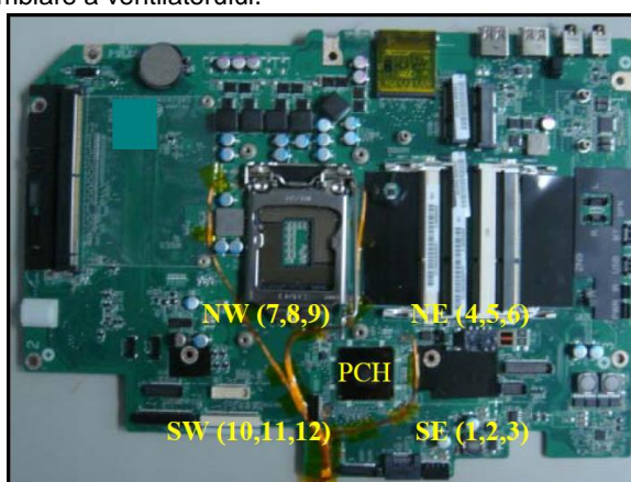
Fig.2.13 PCB-ul de desktop cu rozete (Bin, H. and Ueda, T. (2011))
