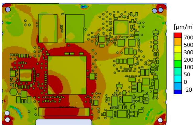
Fig. 5.21 Rezultate simulare pentru deformațiile specifice principale maxime – a) 25 ° C; b) 50 ° C; c) 85 ° C; d) 120 ° C
