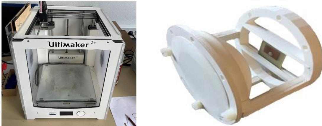
**Figure II-2.** Imprimante 3D et l'antenne réalisée par impression 3D
