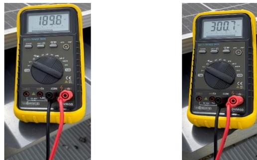
**Figure III-15.** Niveaux DC mesurés en sortie de la rectenna proposée
