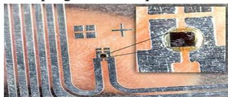
**Figure I-6.** Le circuit intégré et la bobine antenne d'une puce RFID [10]
