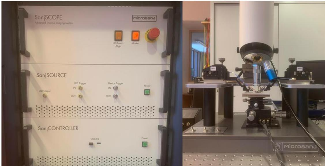
Figure 68 : Banc de mesure Microsanj par thermoreflectance
