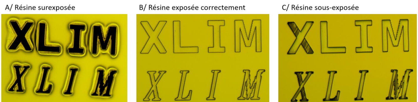
Figure III.27 : Monocouche de film sec DF1050 exposé à différentes doses de modulation laser. (A) La résine a reçu une trop forte dose et a été surexposée ; (B) la résine a reçu une dose correcte de radiation ; (C) la résine n'a pas reçu assez de lumière et est sous-exposée.
