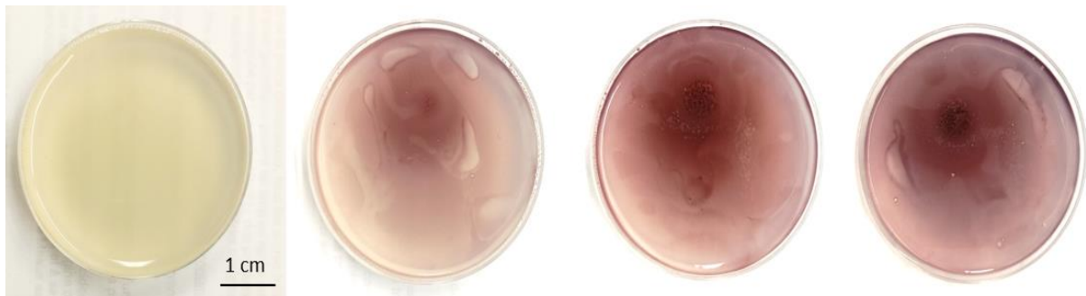
Figure IV-1 : De gauche à droite, témoin non exposé au plasma, échantillons exposés en statique pendant 10 secondes, 20 secondes et 30 secondes pour 200 W, 7 slpm, 30 mm.
