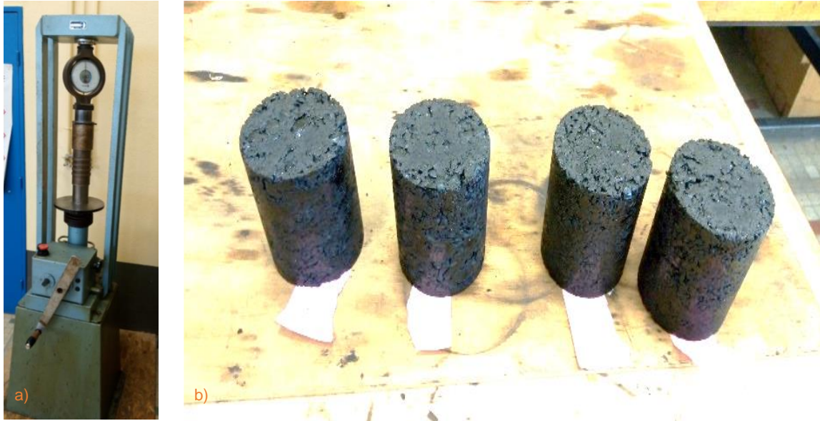
Figure 59 : Procédure de compactage a) Presse b) Quelques éprouvettes d'enrobés de CNP après démoulage
