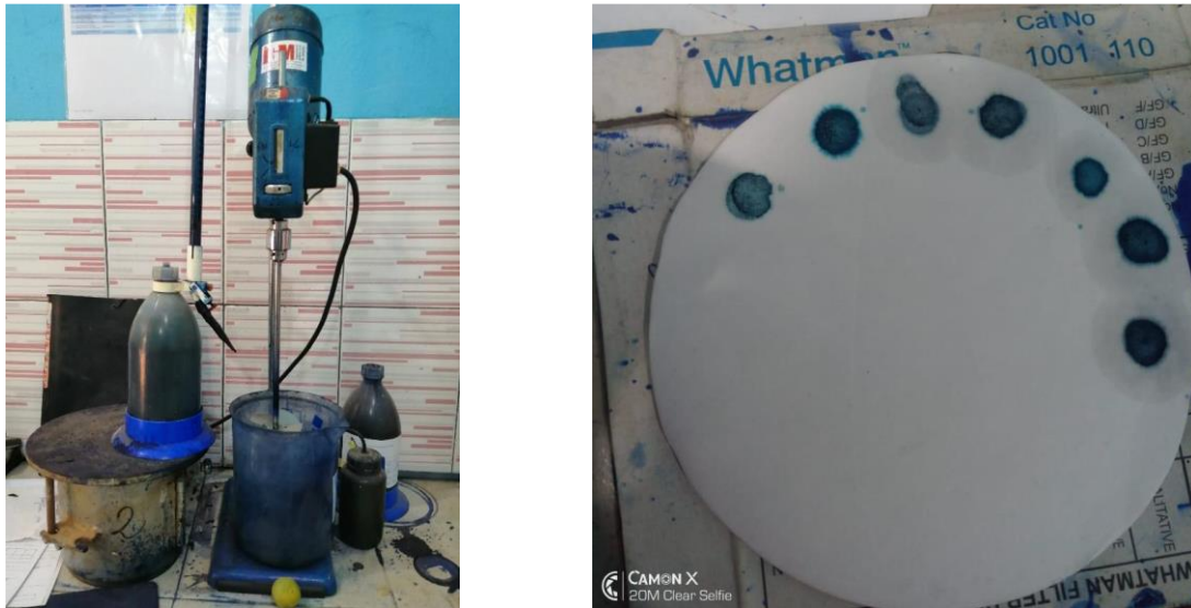
Figure 25 : Matériel d'essai au bleu de méthylène
