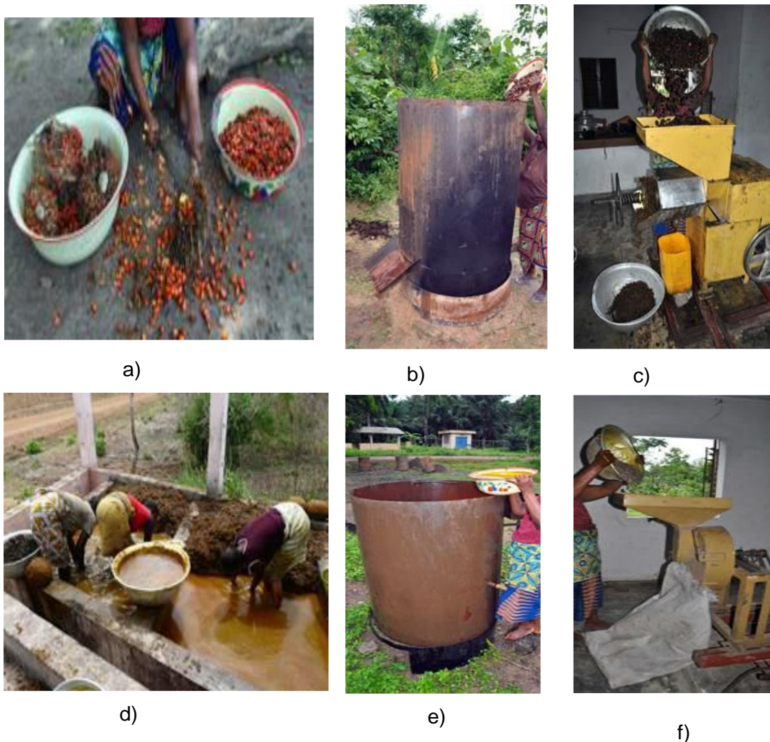
Figure 9 : Processus de production de l'huile de palme a) Egrappage, b) Cuisson, c) Pressage, d) Séparation huile brute/fibres/noix e) Clarification, f) Concassage de noix sèches (GERES, 2013)
