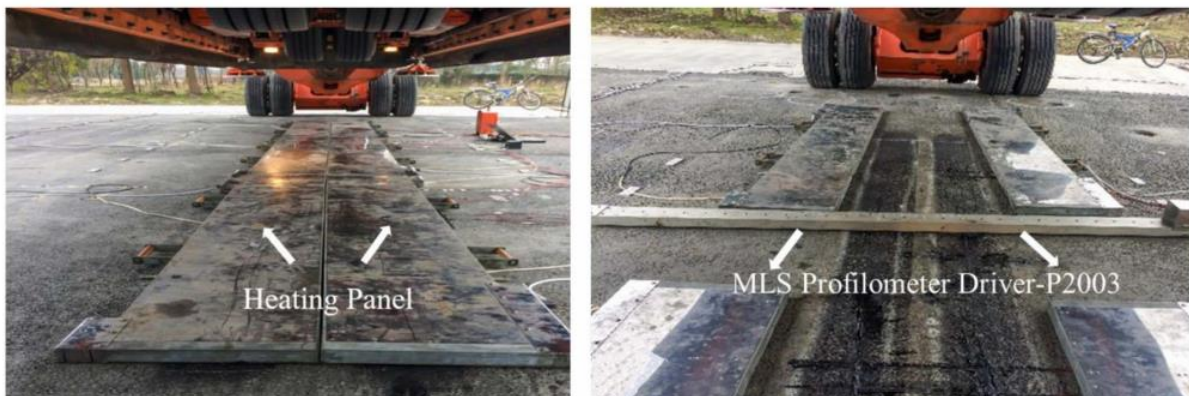
Figure I-28 : Essais en vraie grandeur effectués dans des conditions de températures contrôlées (d'après Ling et al., 2020)
