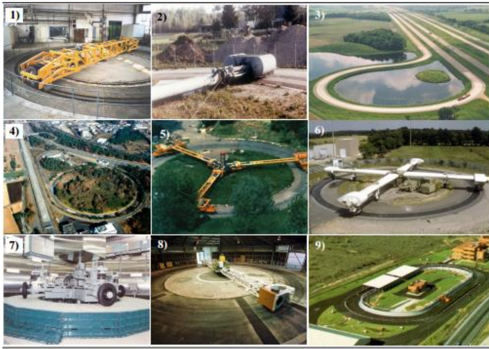
Figure I-26 : Simulateurs de trafic lourd circulaires. 1) Roumanie - 2) Suisse - 3) Minnesota 4) Japon - 5) Slovaquie - 6) France- 7) Japon - 8) Nouvelle Zélande - 9) Espagne (Full Scale / Accelerated Pavement Testing (AFD40), s. d.)
