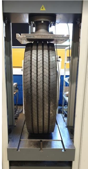
Figure III-13 : Essai de caractérisation du pneu
