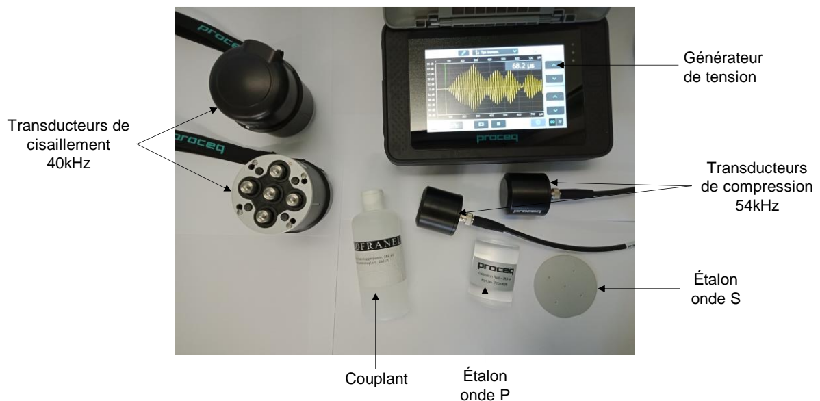
Figure II-18 : Pundit PL-200 et transducteurs d'onde P et S
