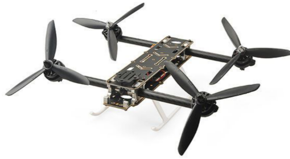
FIGURE 1.14 – Exemple de quadrotor avec tilt-rotors
