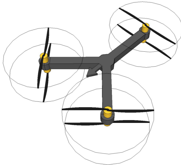
FIGURE 1.5 – Schéma de drone tri-rotor à double hélice
