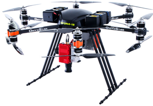
FIGURE 1.8 – Exemple de drone hexa-rotor à double hélice
