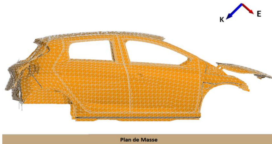
Figure 83 : Illumination du maillage de la carrosserie véhicule par une onde plane (simulation FEKO)
