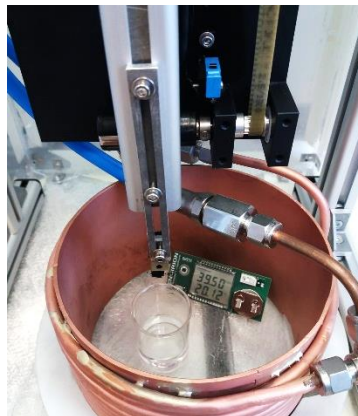
Figure 18: photographie du dip-coater, avec le bras mécanique et le système de contrôle de la température et de l'humidité relative dans la chambre de dip-coating, et le bécher conteneur du sol-gel
