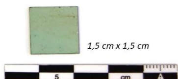
Figure 17: photographie d'un coupon de cuivre de 1,5x1,5cm, découpé dans la plaque de cuivre historique de la toiture de Metz, et représentatif des coupons types utilisés tout au long de cette étude ; avec mire en noir et blanc
