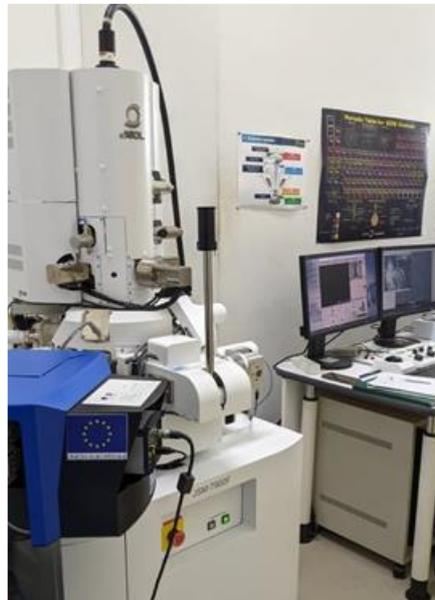
**Figure 2.5: Microscope électronique à balayage "JEOL JSM-7900F" .**
