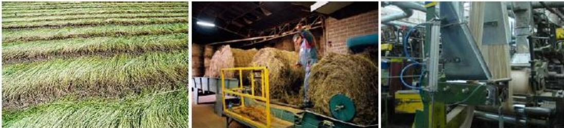
**Figure 1.3: Étapes d'extraction du lin et préparation à la filature : rouissage, teillage et peignage [1,20].**
