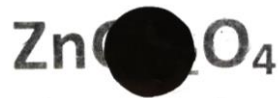
Figure III-18. Photographie d'une céramique \text{ZnGa}_2\text{O}_4 obtenue par frittage SPS de poudre lixiviée (1 mm)
