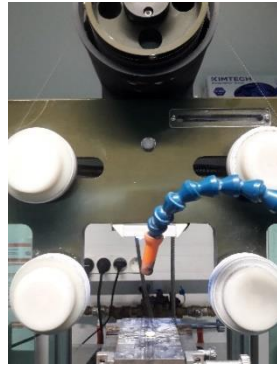
1. Découpe de l'échantillon avec une scie à fil
