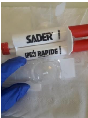
5. Collage de l'échantillon sur la lame de verre à l'aide de résine époxy
