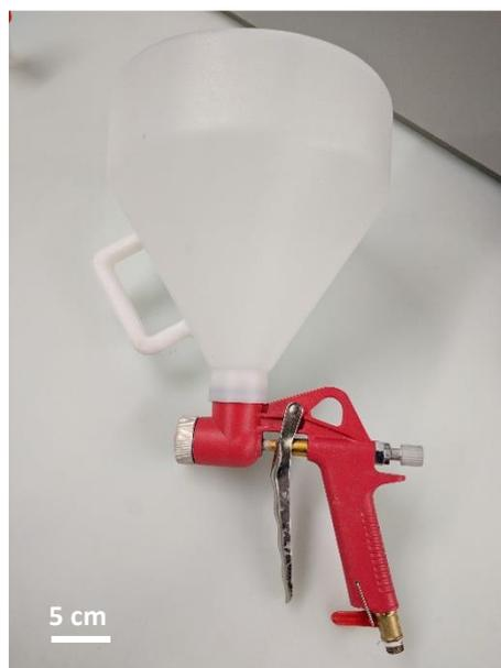
Figure 13 : pistolet à crépir utilisé.
