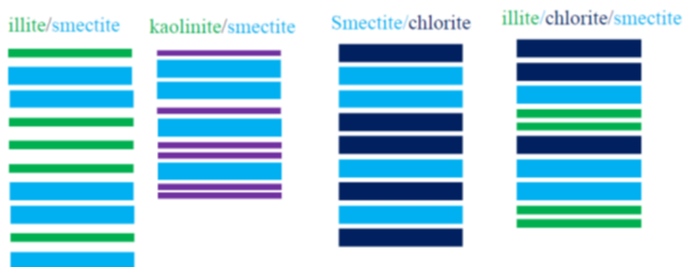
Figure I-7 : Différentes possibilités d'interstratification [40]
