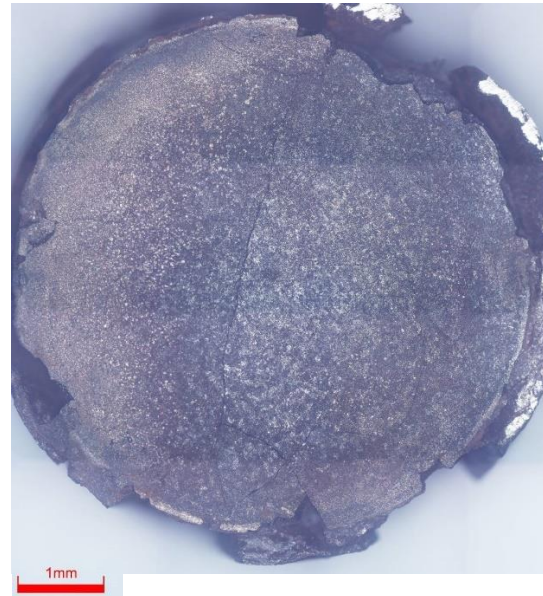
Pastille B7 – pO_2 = 1 \cdot 10^{-12} \text{atm} - \dot{\epsilon} = 1 \cdot 10^{-4} \text{s}^{-1}
