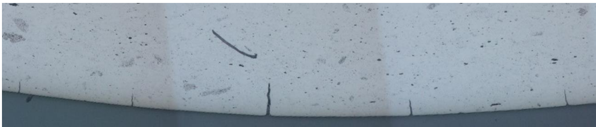
Figure VI-17. Micrographie optique de la fibre externe en traction d'une éprouvette déformée en flexion 3-points. Eprouvette C9 – T = 1500^{\circ}\text{C} ; p_{\text{O}_2} = 6,0 \cdot 10^{-13} \text{ atm.} ; v = 60 \text{ }\mu\text{m} \cdot \text{min}^{-1} ; déformation viscoplastique maximale \sim 13\% .
