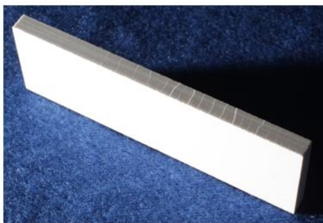
Figure 6.5 : Fissuration observée sur un échantillon de mullite dense après un traitement thermique à 1 100 °C pendant 1 h
