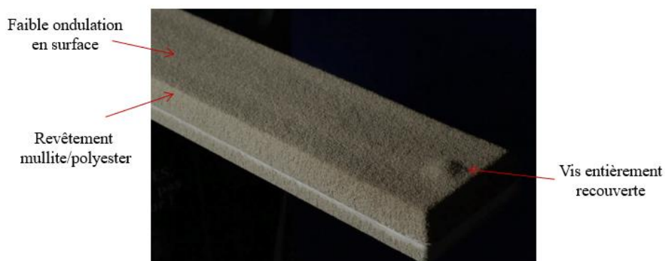
Figure 4.28 : Illustration du recouvrement de la vis utilisée, pour le maintien mécanique du substrat, pour les mesures avec l'ICP, mise en évidence d'un léger phénomène d'ondulation en surface
