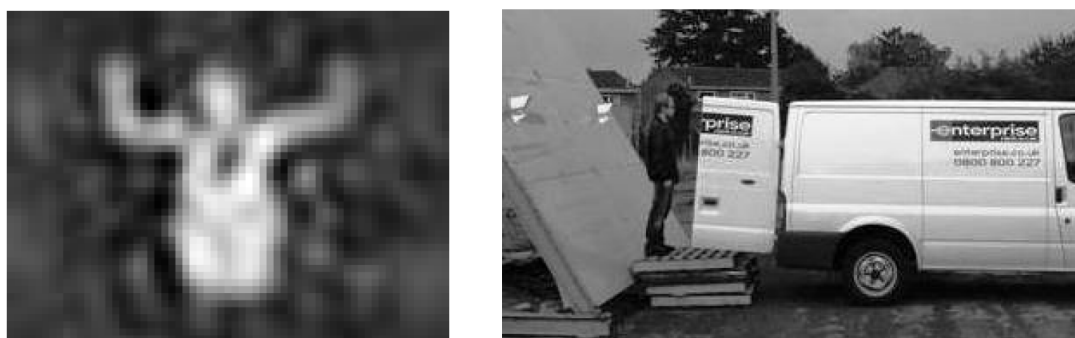
FIGURE 1.23 – Image passive à 22 GHz en environnement outdoor d'un individu placé devant un réflecteur pointé vers le ciel pour augmenter le contraste et mieux cerner le contour de la tête, du torse et des bras de la personne dans l'image [67].
