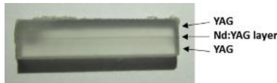
Figure 11. Architecture guide d'onde obtenue par coulage en bande de suspensions céramique [34].
