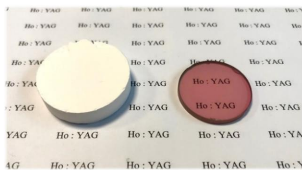
Figure 18. Exemple d'échantillon cru de YAG:Ho puis dense après traitement thermique de frittage.
