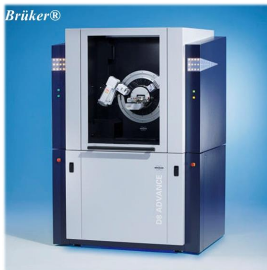
Figure 116. Diffractomètre D8 Advance Da Vinci, Brüker, Billerica, Massachusetts, États-Unis en montage Bragg-Brentano.
