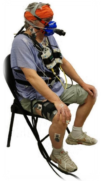
Figure 15. Dispositif expérimental au cours du 1STS. Le participant était équipé d'un analyseur d'échange gazeux et d'un cardiofréquencemètre, d'électrodes EMG et d'une électrode NIRS sur le quadriceps.
