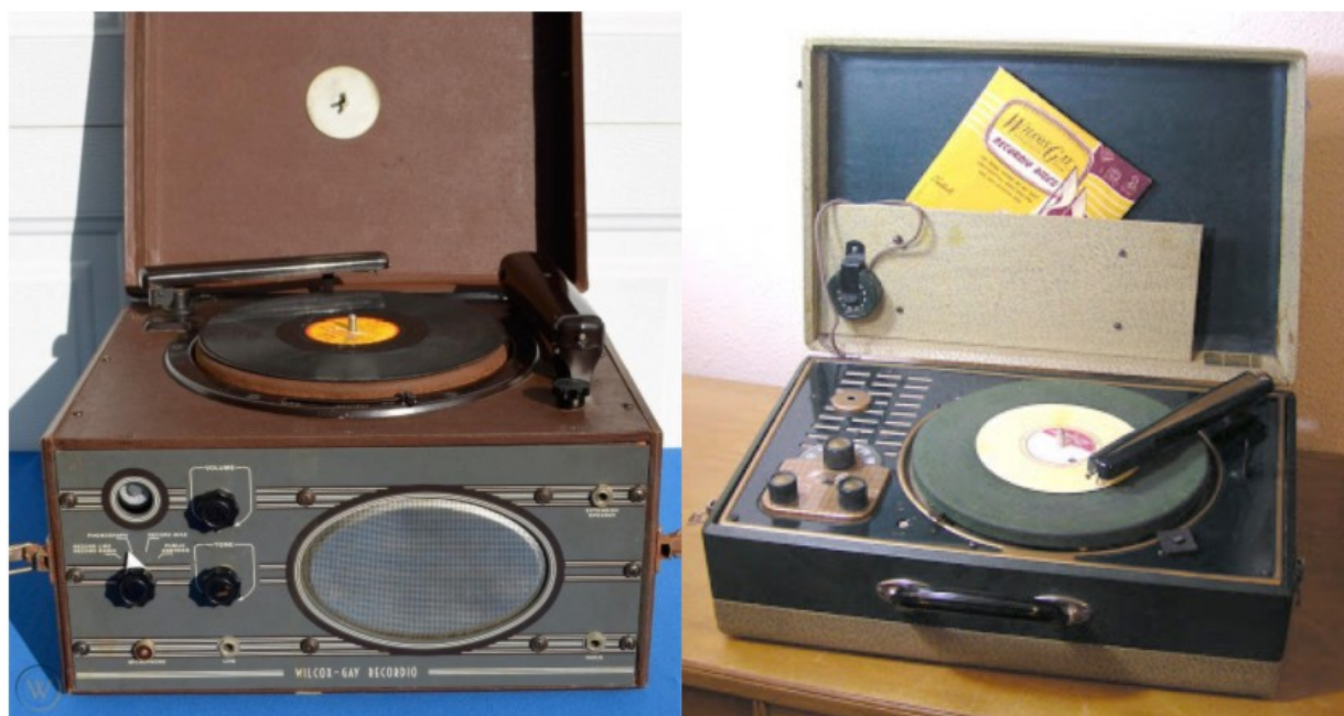
Illustration 16: Wilcox-Gay Recordio, le type de machine permettant d'enregistrer des 78 tours en acétate utilisé par Ruth Rubin au début de ses collectes.
