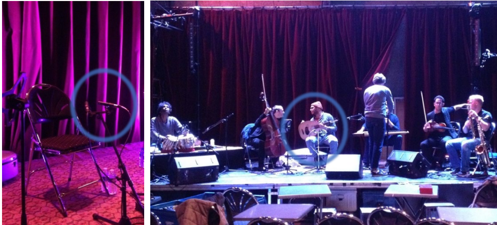
Figures 74 et 75 : couple de micros électrostatiques placés en XY devant le oud 261
