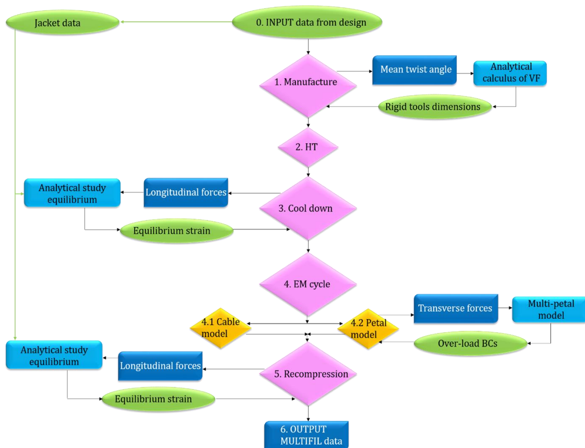
Figure 17. Protocole numérique des simulations de câbles de fusion avec le code MULTIFIL.
