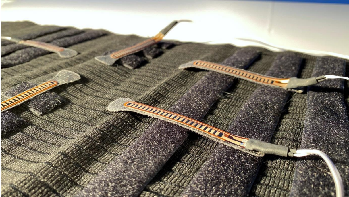
Figure 7.5 : Capteurs de déformation repositionnables placés sur des bandes de velcro cousues sur la ceinture abdominale (noire)
